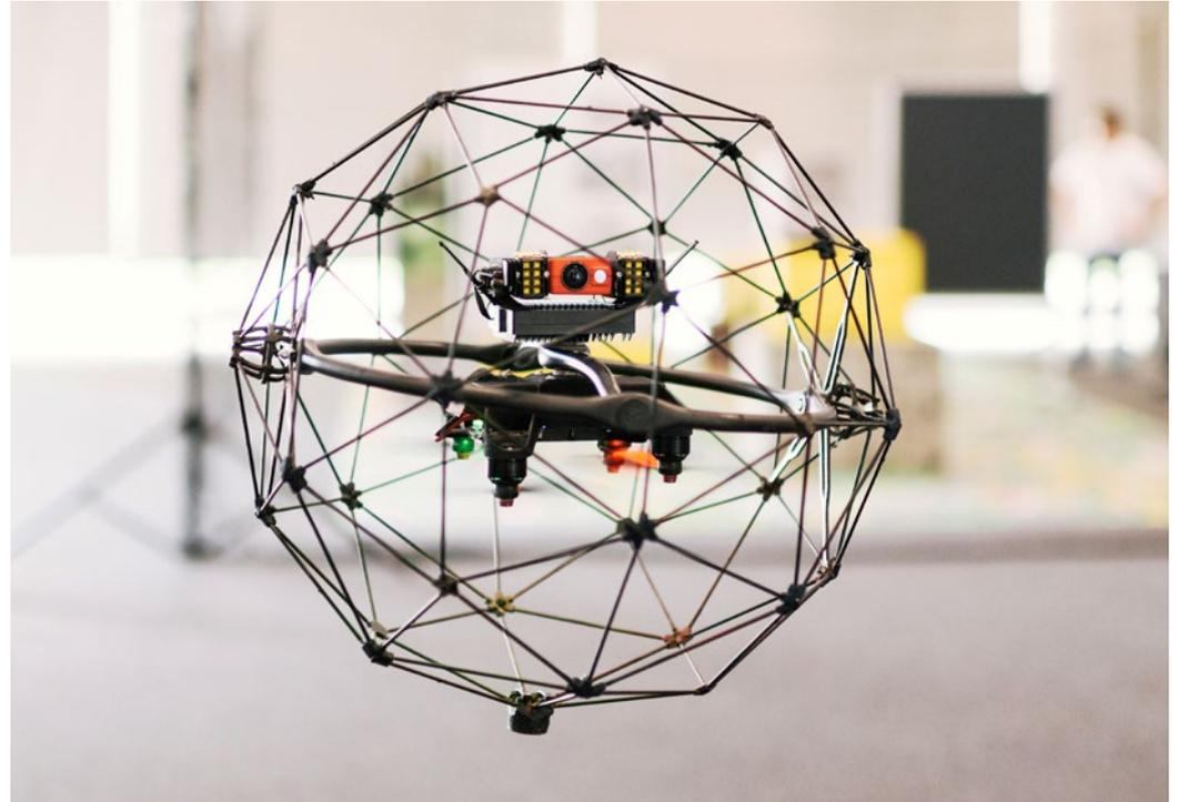
Kollisionen mit Hindernissen aushalten kann», sagt Marc Gandillon von Flyability. Das «Flaggschiff» des westschweizerischen Unternehmens mit 30 Mitarbeitenden heisst Elios. Es zeichnet sich durch einen besonders flexiblen und leichten Rumpf aus. Das
